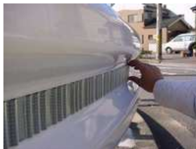
②施工位置を確認し、貼付。 製品全体を軽くなぞる様に、圧着。
