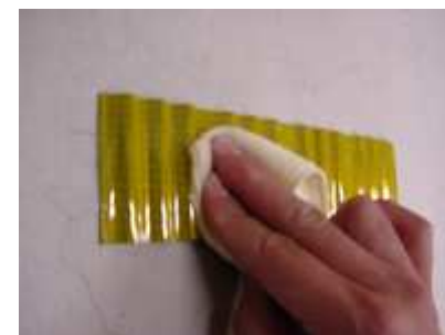
③貼付後、製品全体を軽く、なぞる様に圧着。 製品フラット部分を、上部より強く圧着。
